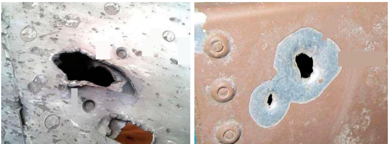
Рис. 1 - Наскрізні пробоїни обшивки крила при вході до поверхні обшивки елемента враження під кутом 60 (а) та 90 (б) градусів
