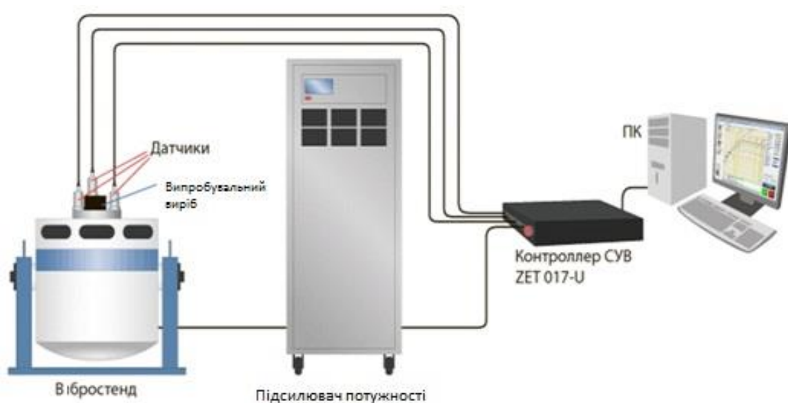
Рис. 2. Блок-схема випробувань вібрації на базі системи управління вібростендами ZET 017-U
