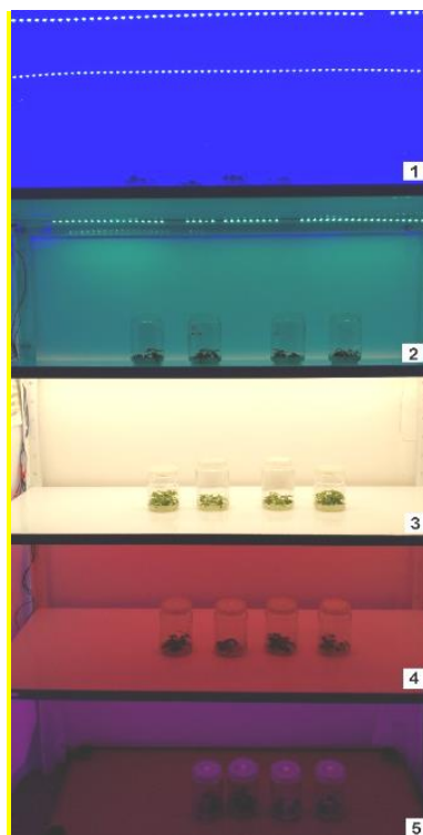
Рис. 1. Установка для вивчення впливу різного освітлення на морфологічні та біохімічні показники експлантів ожини
