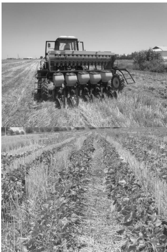
Рис. 1 - Посев машина сеялкой для нулевой технологии (сверху); машина на поле с нулевой обработкой почвы в Узбекистане (снизу)
