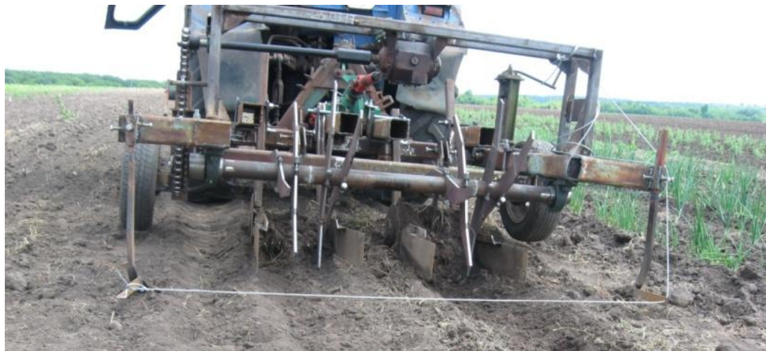
Рисунок 3. Загальний вигляд установки для поверхневого обробітку ґрунту з гнучким робочим органом у вигляді тросу
