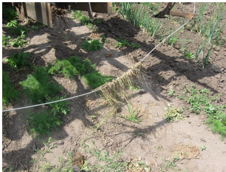
Рисунок 7. Загальний вигляд гнучкого робочого органу з видаленими бур'янами
