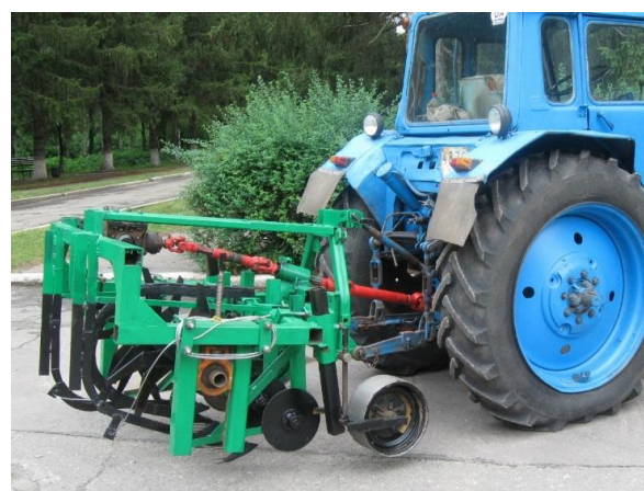
Рисунок 2. Ґрунтообробна польова установка на базі роторного культиватора КПП-1
