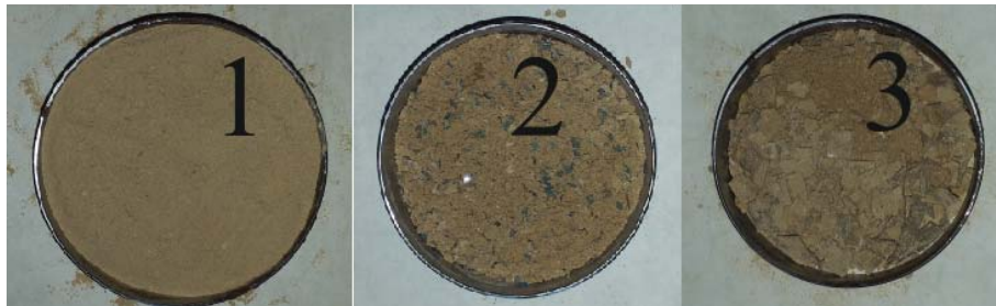
Рис 1. Загальний вигляд компонентів суміші: 1 – суглинок лесовий природньої вологості; 2 – суміш суглинку лесованого та подрібнених пластикових відходів (2 мм) в пропорції 90:10; 3 – суміш суглинку лесованого та подрібнених пластикових відходів (5 мм) в пропорції 90:10.
