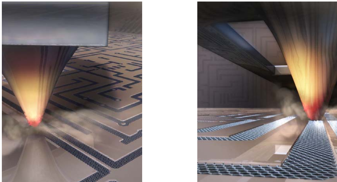
Рис. 7.24. Зображення зонда для трмохімічної нанолітографії
