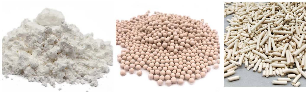
Рис. 5.10. Промислові молекулярні сита
