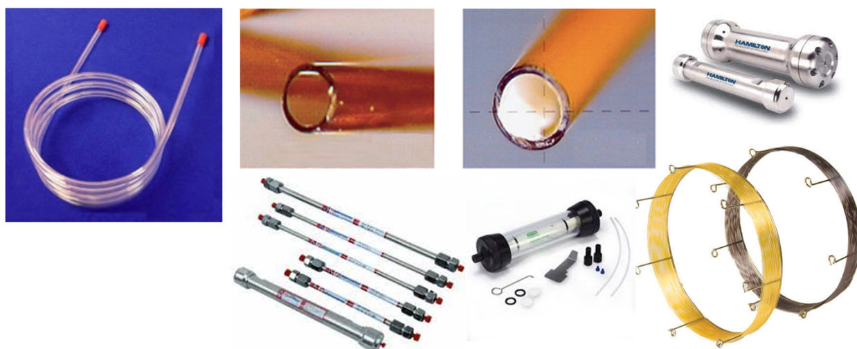
Рис. 5.11. Різновиди хроматографічних колонок
