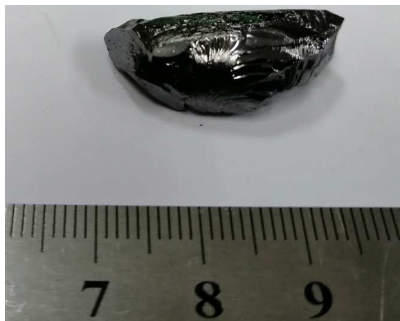
Рис. 4. Монокристал \text{Ag}_8\text{GeS}_6 вирощений методом спрямованої кристалізації.
