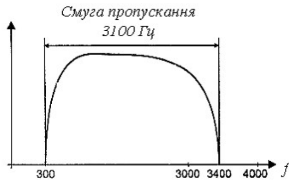
Рис. 4.1: Амплітудно-частотна характеристика каналу тональної частоти
