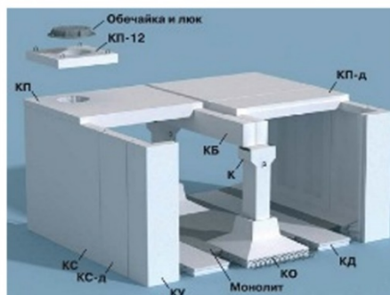
Рис. 3 а - Колектор з об'ємних елементів; б - Колектор з лоткових елементів; в - Колектор з кутових стінових блоків;
