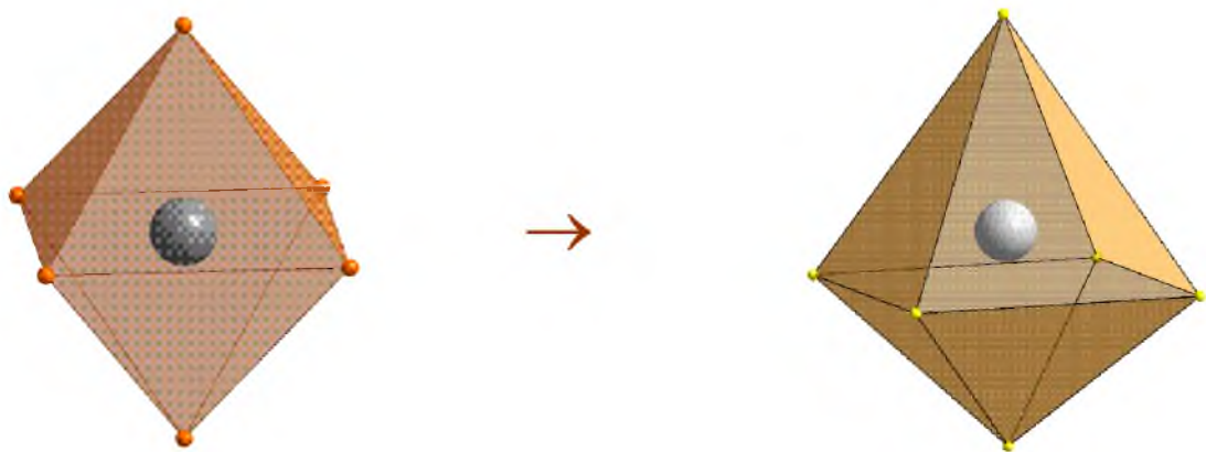
Рис.57. Деформація октаедрів аніонної групи [\text{BX}_6] у структурі сполук типу \text{Tl}_4\text{BX}_3 при переходів від просторової групи I4/mcm до P4/ncc
