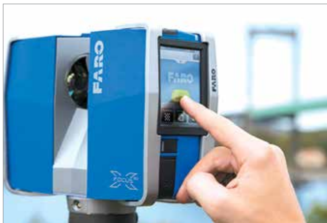
Рис. 1. Обладнання, що використовується для сканування – Наземний лазерний сканер FARO Focus3D X330 Fig. 1. Device, used for scanning – Terrestrial laser scanner FARO Focus3D X330
