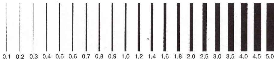
Рис. 6. Шкала визначення розміру тріщин
