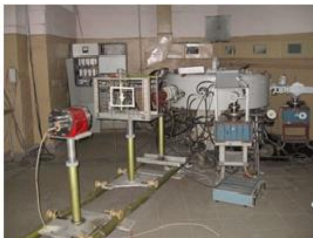
Рисунок 5. Пультова та метрологічна лава для радіаційних випробувань матеріалів та приладів космічного призначення мікротрону М-30
