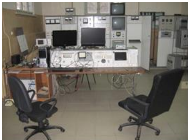
Рисунок 5. Пультова та метрологічна лава для радіаційних випробувань матеріалів та приладів космічного призначення мікротрону М-30
