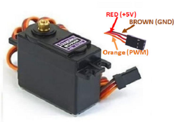
Рисунок 3.4 - Зовнішній вигляд та розміри сервопривода MG996R
