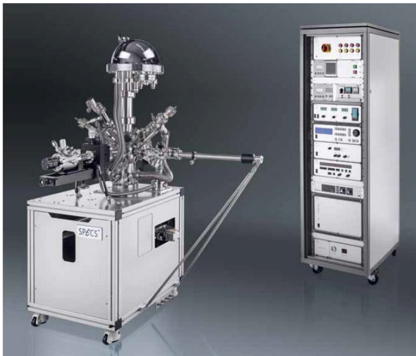
Рис. 2.6. Загальний вигляд установки (Specs GmbH, Берлін, Німеччина) для вимірювання рентгенофотоелектронних спектрів.
