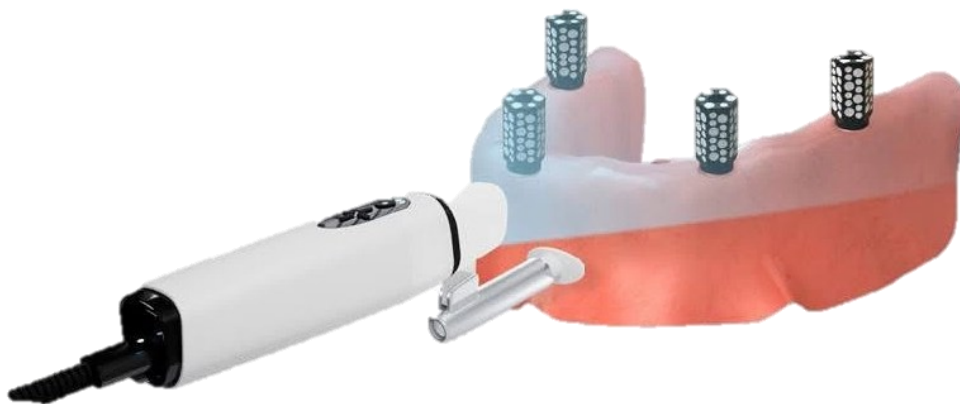
Рис. 3. Принцип фотограмметричної реєстрації положення дентальних імплантатів із застосуванням інтраорального сканера Freedom Air, DOF (DOF, Південна Корея)
