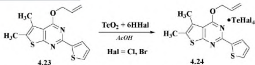
Рис. 4.13. Загальна схема утворення молекулярних комплексів 3.78 .
