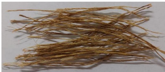
Рис. 2. Волокно, отримане з хвої сосни звичайної
