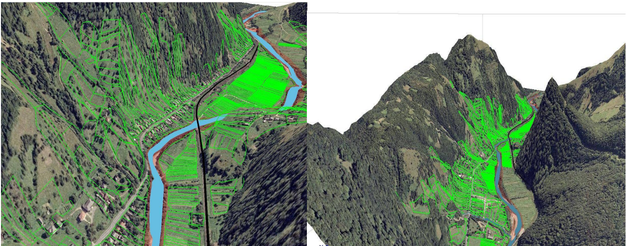
Рис.4 3D модель при встановленні прибережних захисних смуг з врахуванням особливих умов забудови
