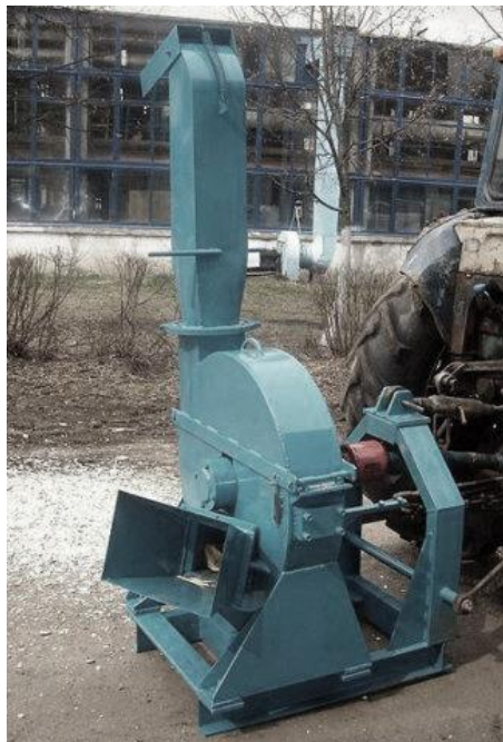
Рис. 1. Мобільна модифікація подрібнювача (привод від ВВП трактора)
