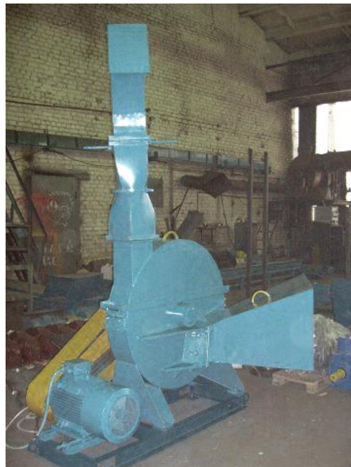
Рис. 2. Стационарна модифікація (привод від електричного двигуна)
