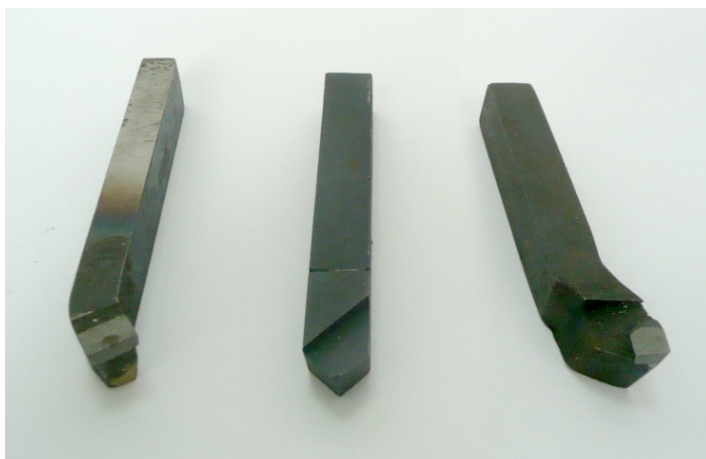
Різні види і типорозміри різців, отриманих за технологією металотермічного приварювання інструментальної пластини
