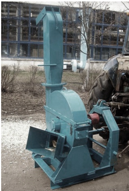
Рис. 1. Мобільна модифікація подрібнювача (привод від ВВП трактора)
