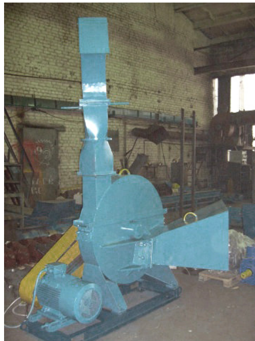
Рис. 2. Стационарна модифікація (привод від електричного двигуна)
